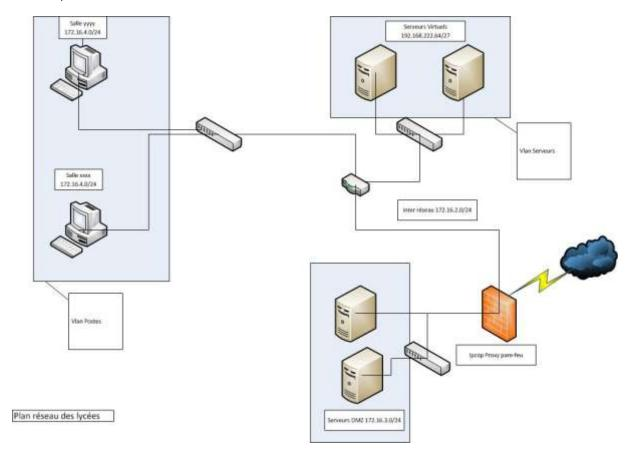
Les matériels d'interconnexion des différents Vlan entre eux sont des commutateurs CISCO 2960 et un routeur CISCO 2901. Les serveurs sont des serveurs virtuels hébergés dans une ferme de serveurs ESX composé de deux serveurs en cluster avec déplacement automatique des machines virtuelles en cas de problème sur un des deux serveurs ESX.
